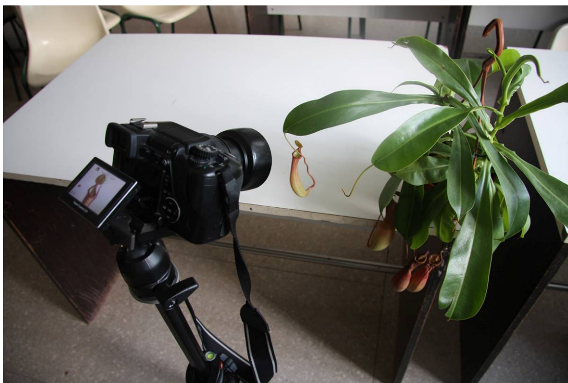
Figura 16. Muntatge de la càmera Olympus E330 amb trípode al laboratori de biologia. Es pot veure en la pantalla LCD de la càmera el subjecte en temps real ( live view ).
