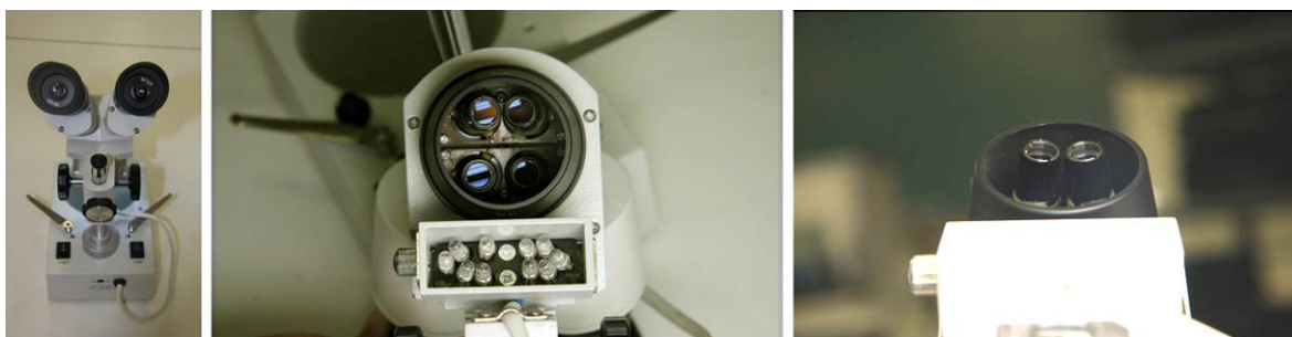
Figura 14. Lupa binocular vista superior (esquerre) vista inferior de la lupa amb els seus quatre objectius, 2x i 4x, i les llums incidents (LEDs en aquest cas). A la dreta, visió inferior obliqua per apreciar millor els dos objectius que s'utilitzen simultàniament.
