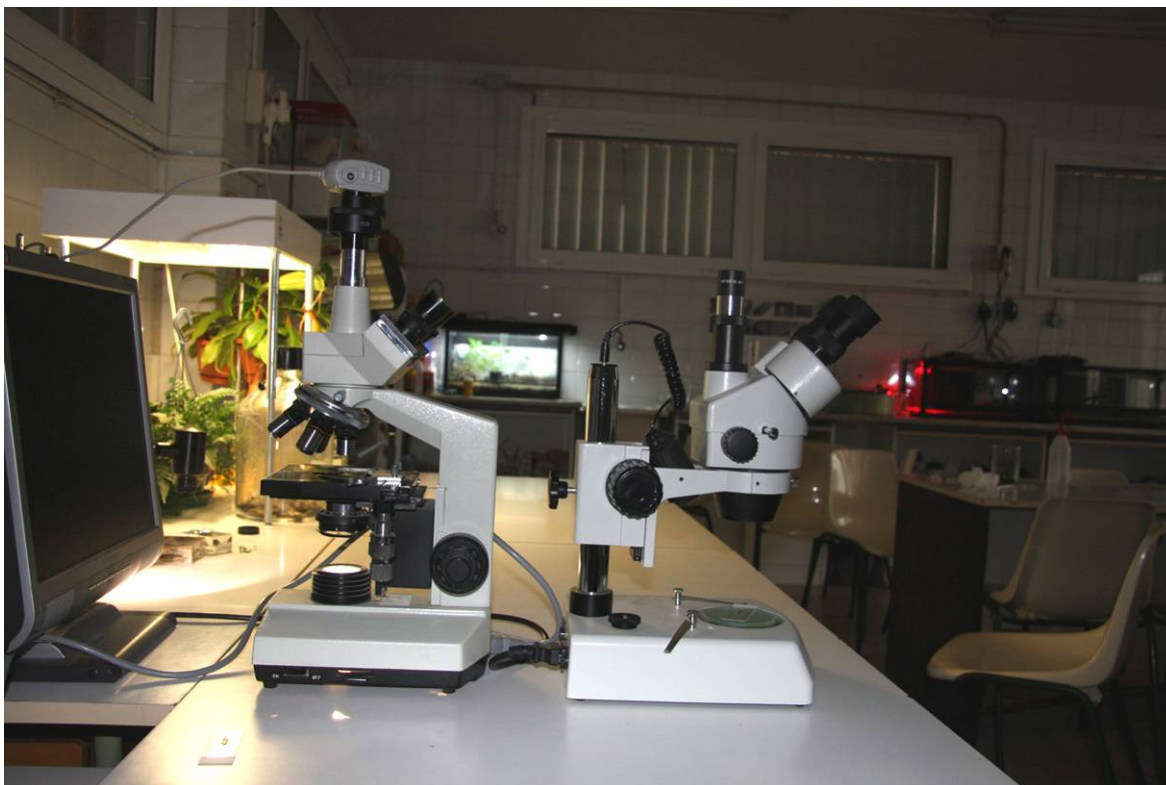
Figura 15. Per diferenciar externament un microscopi òptic (esquerra) d'una lupa binocular (dreta) ens hem de fixar amb la platina mòbil (amb un forat central) i el revòlver amb 4 o 5 objectius, ambdós exclusius del microscopi òptic; per la seva part, la lupa binocular utilitza dos oculars i dos objectius alhora que li confereix característiques estereoscòpiques úniques. (En la imatge també es pot observar una càmera acoblada al tercer ocular del MO).
