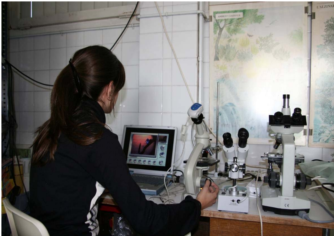
Figura 1. Primera càmera de vídeo (Moticam 352) connectable a un microscopi al laboratori de biologia de l'Escola. La imatge es projecta directament a la pantalla de l'ordinador mitjançant un software especial (extret de Alba Soria, 2008).
