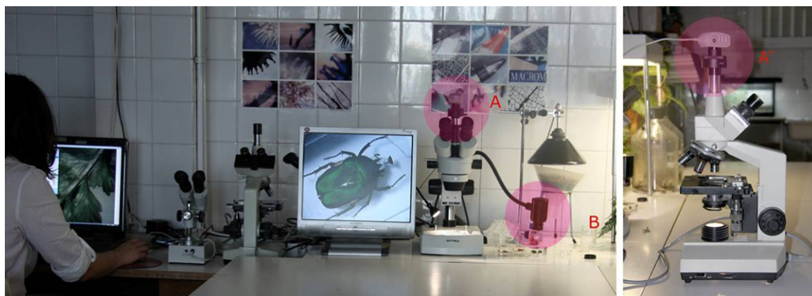
Figura 13. Estació de microfotografia al laboratori de biologia de l'escola on s'indiquen els dos tipus de càmeres de vídeo amb objectiu macro utilitzades: Moticam acoblada a la lupa binocular (A) o al microscopi (A'), connectada a l'ordinador, i càmera Optika de braç flexible (B) connectada a la pantalla de televisió, en la que podem veure el motiu ocupant tota la pantalla.
