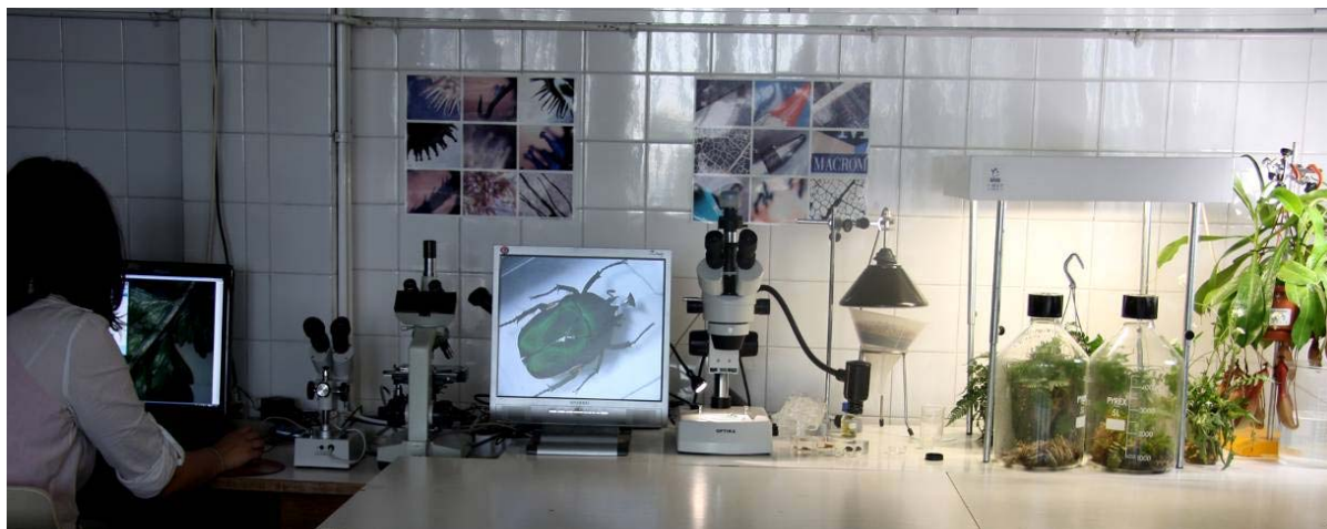
Figura 2. Vista general actual de l'estació digital de fotomacrografia i fotomicrografia del laboratori de biologia de l'Escola. El monitor central, funcionant com a pantalla de TV, està captant la imatge de la càmera de vídeo de braç flexible de la dreta, mentre que a la pantalla de l'ordinador s'observa la captura realitzada per la càmera Moticam MC-1000 connectada a la lupa binocular. Les imatges que decoren la paret són fotomicrografies realitzades per Alba Soria amb la càmera Moticam 352 (vegeu Figura 1).
